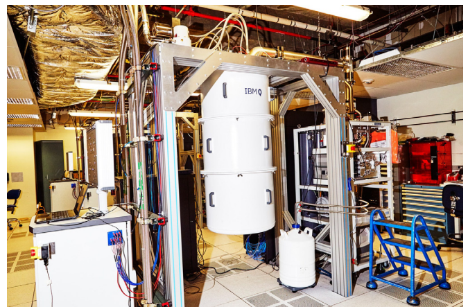
هرگاه کیوبیت‌ها در حدی سرد شوند که بتوانند کار کنند، کل دستگاه در این جعبه عایق سفید جای می‌گیرد.
