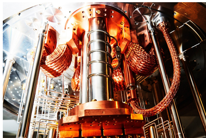
ساختارهای مسی حرارت را به خوبی انتقال می‌دهند و دستگاه را به سیستم کنترل آن وصل می‌کنند.
